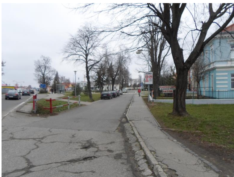
Foto č. 33: Jednosmerka na Břeclavskej ulici – s povoleným vjazdom cyklistov do protismeru. Zmenu organizácie dopravy je vhodné doplniť aj vodorovným dopravným značením – cyklopiktokoridor, prípadne v cyklistu v protismere vyznačiť cyklistickým pásom so zeleným podfarbením.
