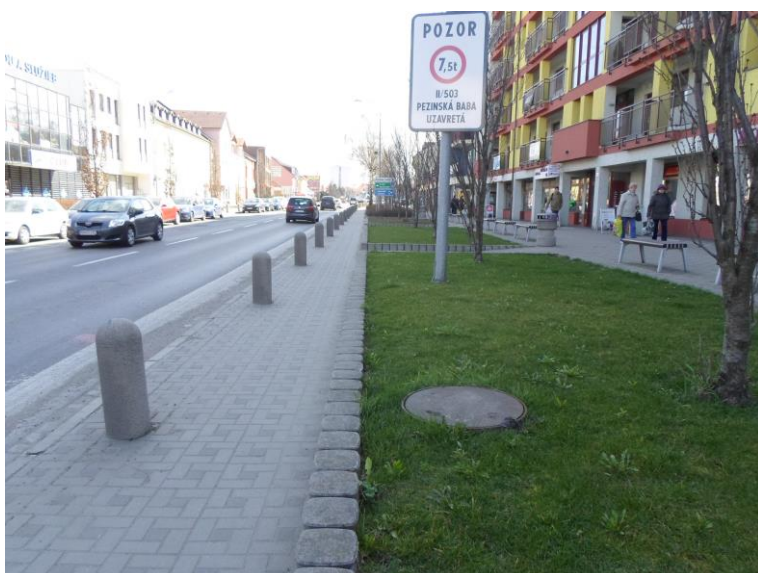
Foto č.8: Záhorácka ulica od križ. Pribinova – chodník na pravej strane navrhujeme preklasifikovať na samostatnú cyklistickú cestičku. Zároveň je nevyhnutné ho rozšíriť na úkor zelene po pravej strane a odstrániť betónové stĺpiky pri obrubníku.
