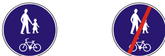
Obr. č. 5: Zvislé dopravné značenie – začiatok C12 a koniec C18 združeného priestoru pre chodcov a cyklistov. Chodci a cyklisti sú vedení na spoločnej MK bez akéhokoľvek vizuálneho či fyzického oddelenia.
