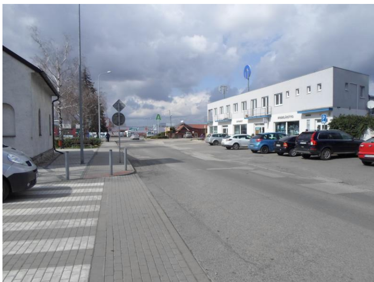
Foto č. 32: Ul. 1. mája – dostatočná šírka jestvujúcej MK umožňuje vyznačiť cyklistické pruhy v oboch smeroch.
