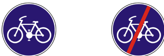
Obr. č. 1: Zvislé dopravné značenie – začiatok C8 a koniec C18 samostatnej cyklistickej cestičky.
