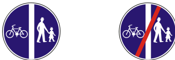
Obr. č. 4: Zvislé dopravné značenie – začiatok C13 a koniec C18 samostatnej cyklistickej cestičky primknutej k chodníku pre chodcov. Oddelenie chodcov a cyklistov fyzickou prekážkou.
