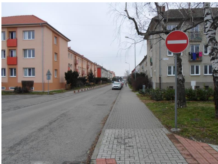
Foto č. 43: Ul. 1. mája (od Břeclavskej po Pribinovu) – jednosmerná ulica, do ktorej navrhujeme povoliť protismerný vjazd cyklistov. Zároveň sa na MK vyznačí vodorovným dopravným značením protismerný cyklopiktokoridor (rez č. 19).
