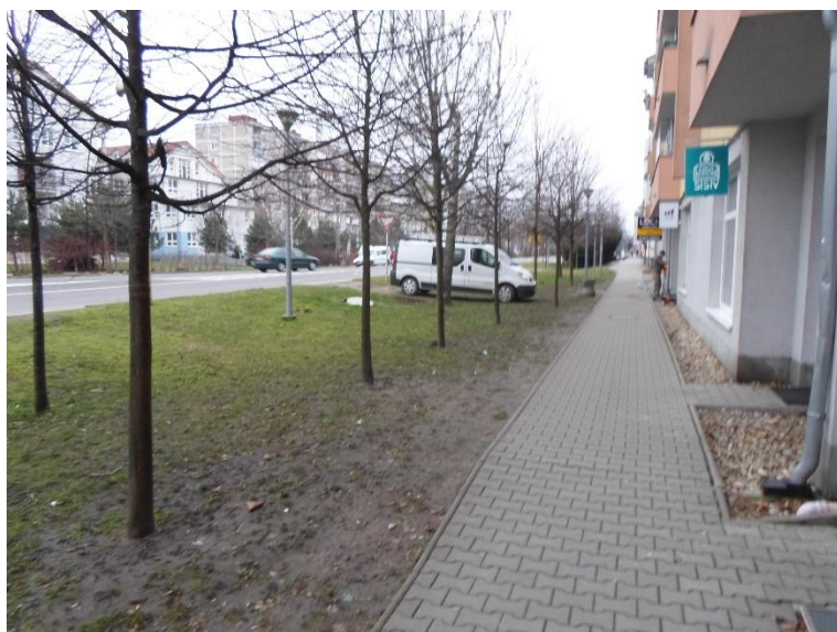
Foto č. 7: Ďalší úsek Záhoráckej ulice – cyklisti budú vedený formou samostatnej cyk. cestičky primknutej k existujúcemu chodníku pre chodcov (oddelenie varovnou dlažbou).
